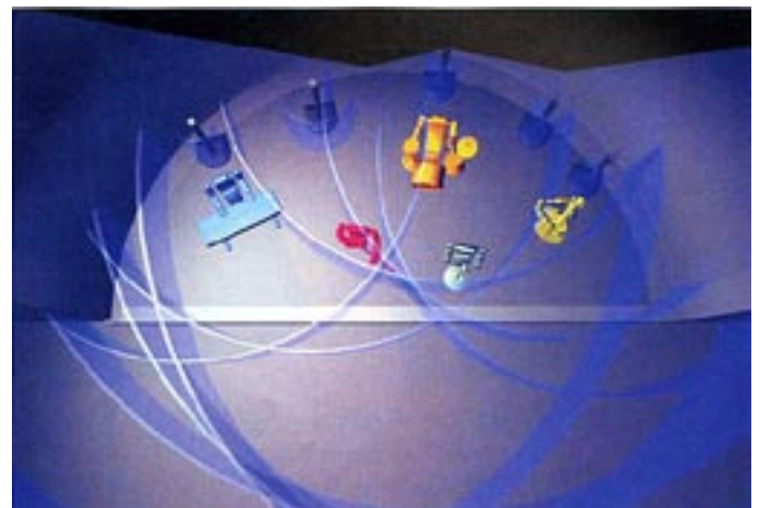
La configuration typique du système Bose avec une colonne de diffusion, en fond de scène correspondant à chaque musicien
